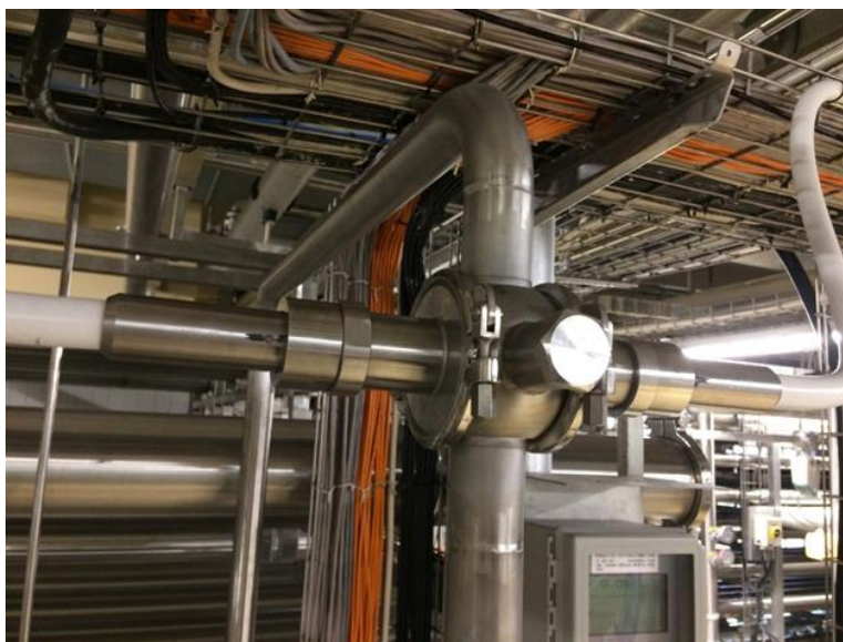
Figur 6: Målecelle til Inline Ostemælkstandardisering.
