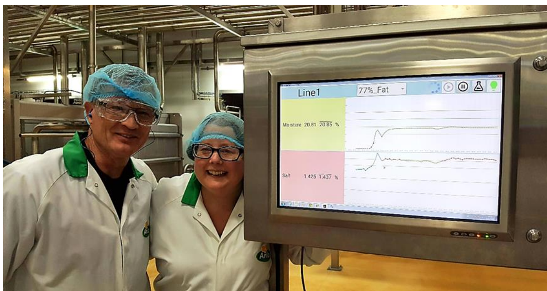
Figur 7: InSight Pro Inline analysator i Storbritannien.
