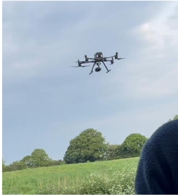
Billede af DJI Matrice 300 udstyret med termisk- og RGB Zoom-kamera DJI Zenmuse H20T anvendt til lokalisering af rådyrlam.
