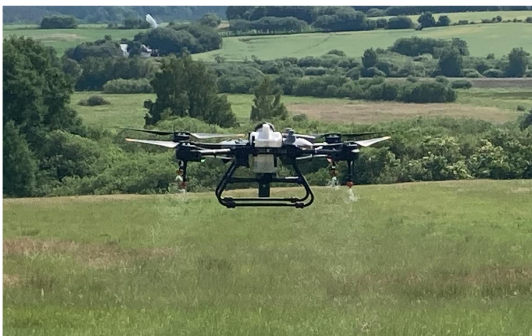
Figur 4. Sprøjt drone DJI Agras T10 monteret med 8 l tank og 4 Lecher 040 Twin Fan injectordyse.
