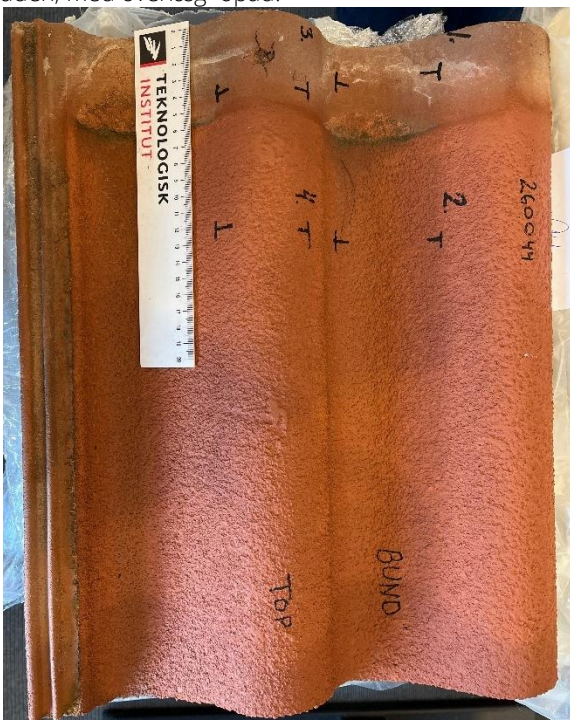
Organisk væks delvist fjernet. Prøveplacering markeret med sort. Overkanten af pladen, med overlæg opad.
