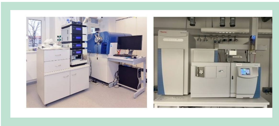
FIGUR 6. Instrumenterne der blev brugt til non-target screening. LC-QToF-HRMS til venstre og GC-Orbitrap-HRMS til højre. Foto: Annegrete Ljungqvist.
