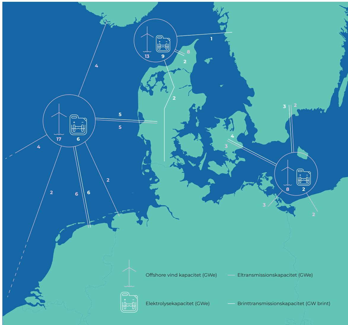
Figur 21: Kapacitet af offshore el og brint forbindelser til og fra Danmark i 2040
