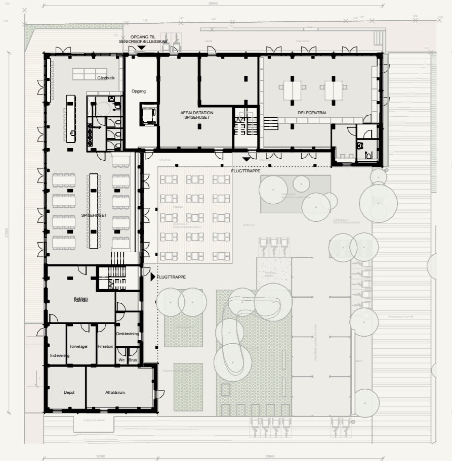
Stueetage med fælleslokaler for hele bygningen / Bofællesskabet
